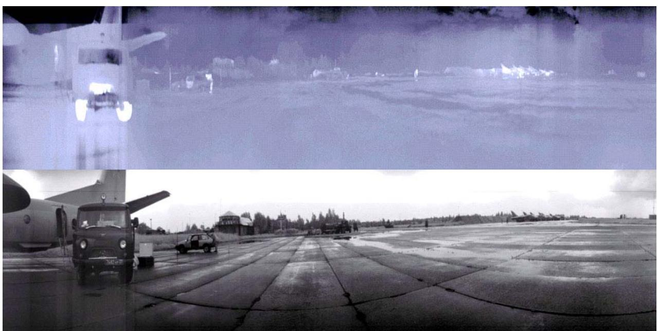
Рис.4. Фрагменты изображений при наземной съемке с помощью однокоординатной поворотной платформы: вверху ИК изображение (8-12 мкм), внизу УФ изображение (0,3-0,4 мкм).
