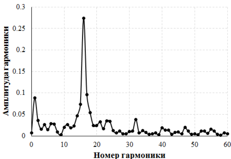
Рисунок 4. Амплитудный спектр отклонений радиуса для круговой траектории.
