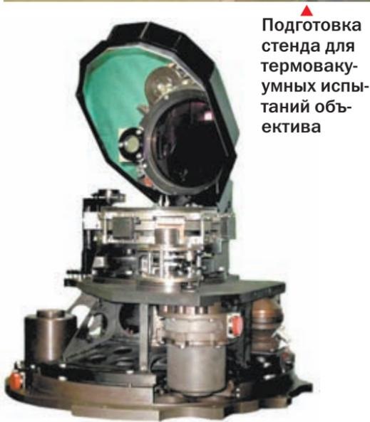
▲ Подготовка стенда для термовакuumных испытаний объектива
